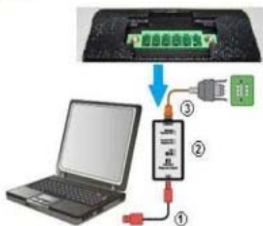
Schéma de câblage lors de l'utilisation d'un UDA2-CS avec connecteur 6 pins
